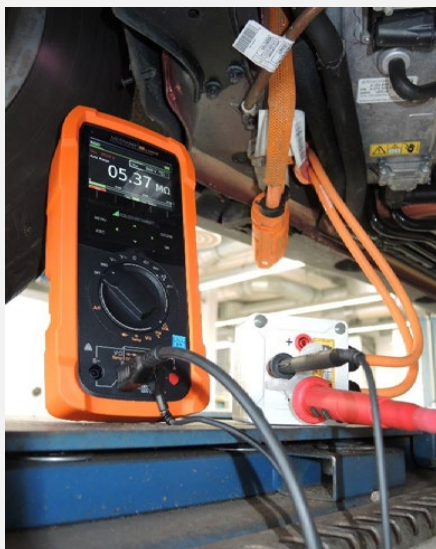
Isolationsprüfung mit METRAHIT IM E-DRIVE im Kfz-Hochvoltbereich (GOSSEN METRAWATT)
